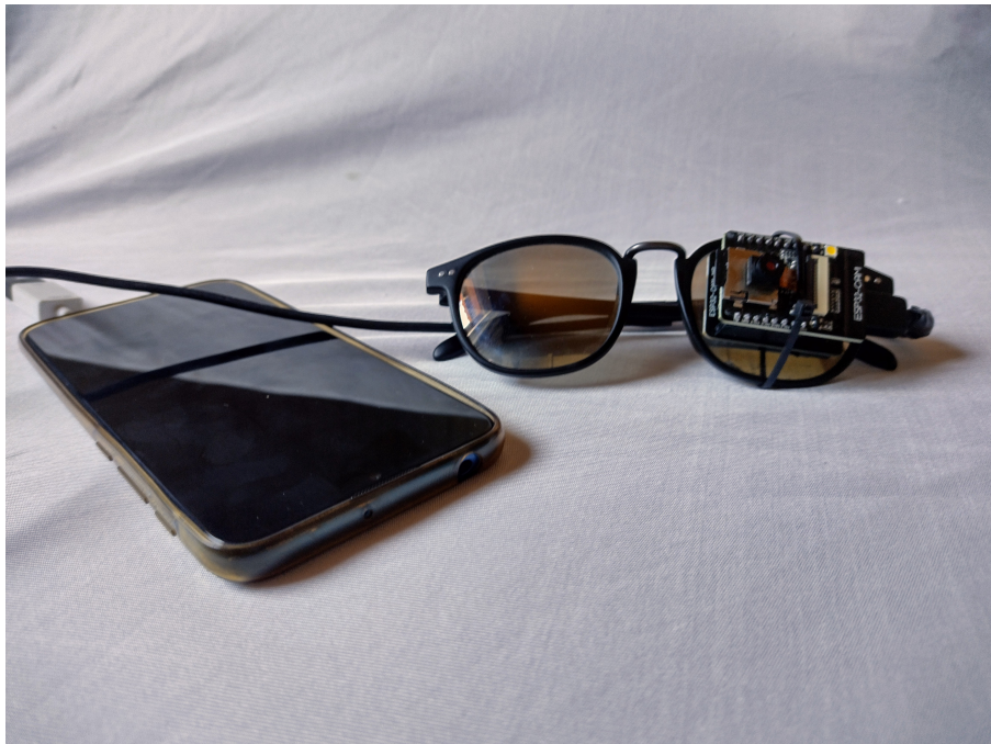
Figura 14 – Imagens do protótipo com o ESP32-Cam
