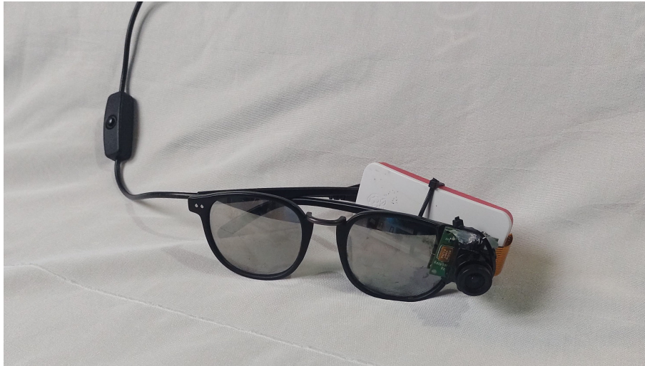
Figura 16 – Imagens da Placa RaspBerry Pi Zero W e a câmera integrada
