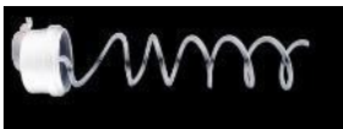
Figura 18 – Mola helicoidal produzida com arame galvanizado.
