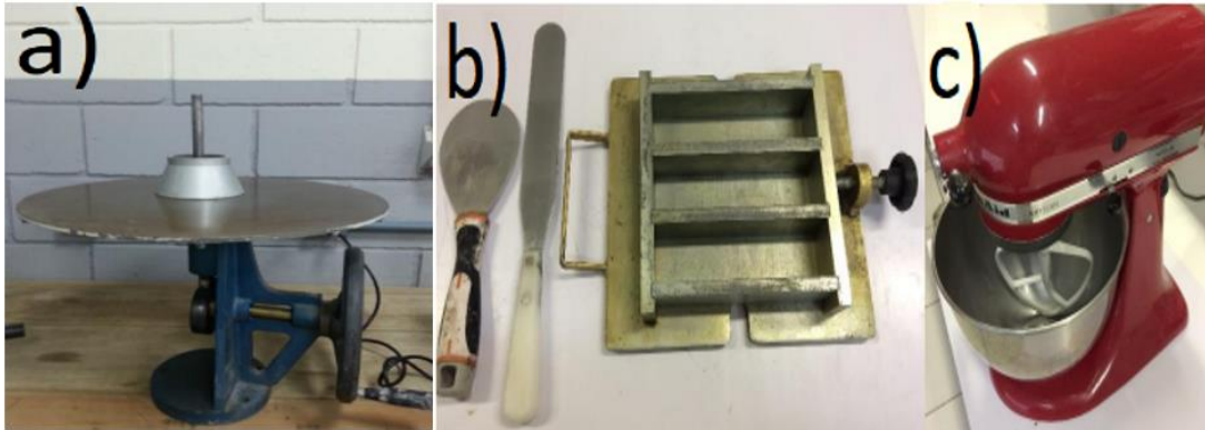
Figura 1 - (a) mesa de consistencia, (b) espátula e molde para corpo de prova, (c) misturador.
