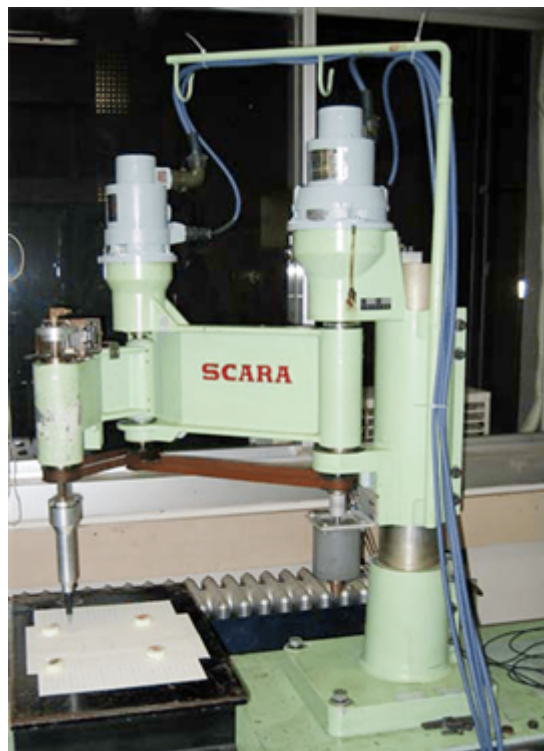
Figura 1 – Um dos primeiros protótipos do robô SCARA.
