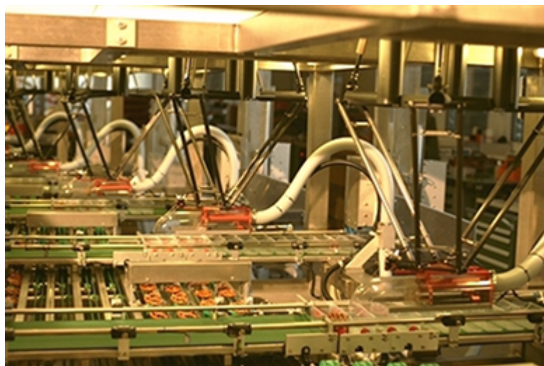
Figura 2 – Robôs Delta na célula de manufatura da companhia DEMAUREX SA®, empacotando pretzels.
