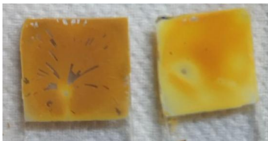
Figura 15: Imagem fotográfica dos filmes de \text{TiO}_2 , a direita, e \text{TiO}_2 -TX, esquerda, sinterizados a 200^\circ\text{C} , após sensibilização pelo corante alaranjado de metila.
