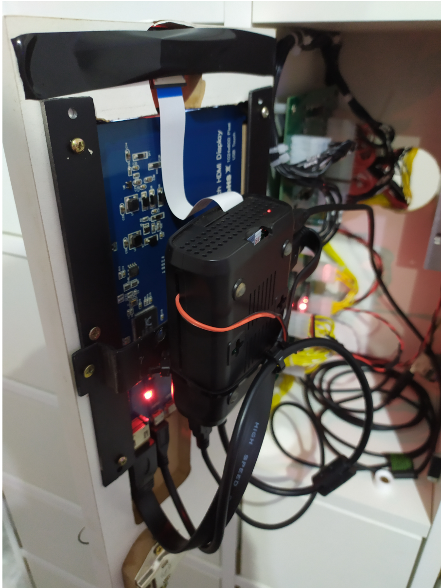
Figura 56 – Parte interna, mostrando a tela touchscreen e a Raspberry Pi 3B.
