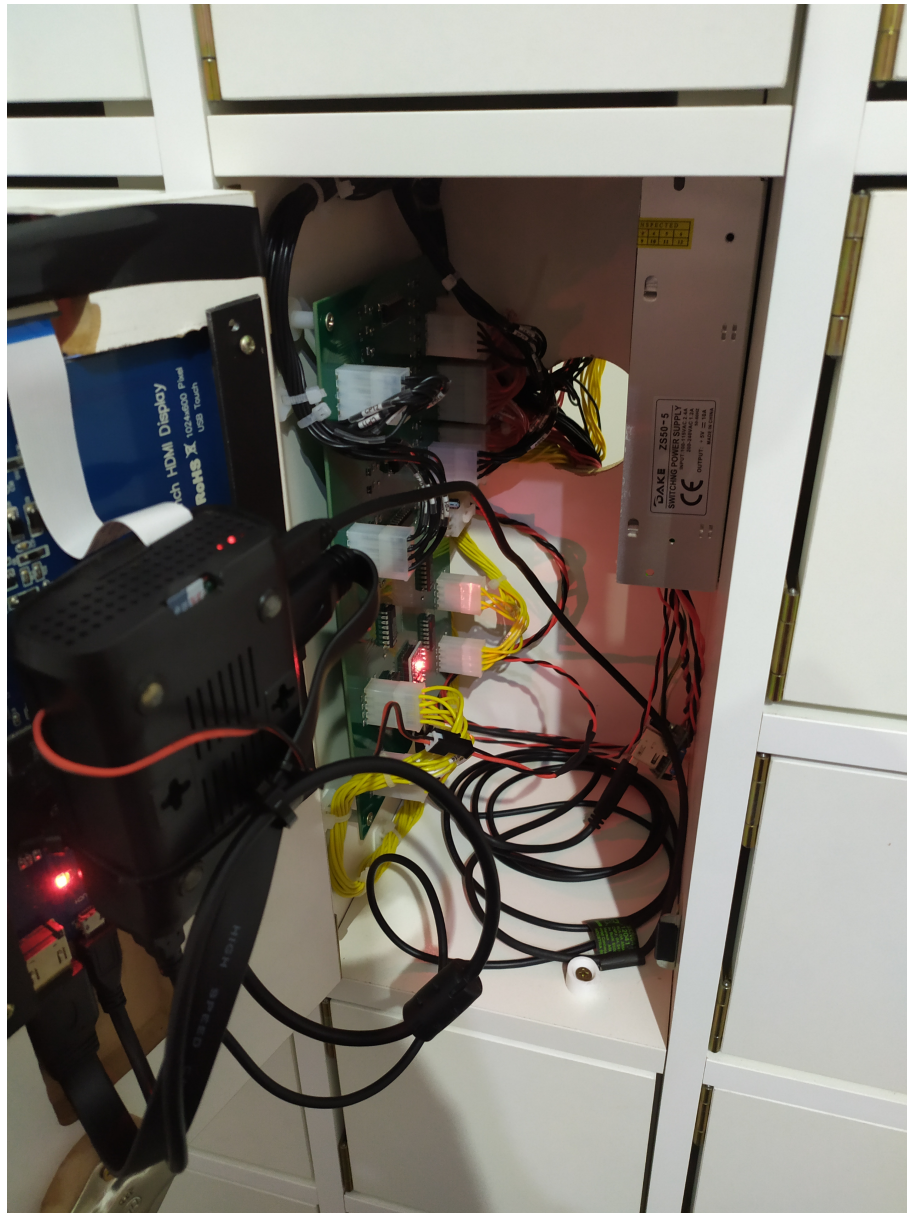
Figura 51 – Visão interna dos seguinte componentes da direita para esquerda: fonte 5V, placa auxiliar, Raspberry Pi 3B e tela touchscreen.
