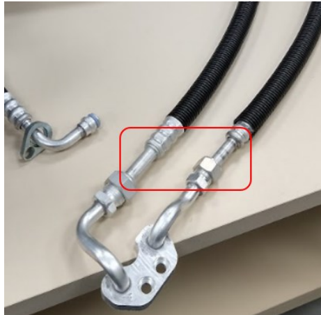
Figura 17 - Conexão das mangueiras sem válvulas.
