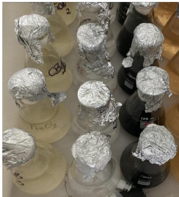
Figura 8 - Teste de degradabilidade. Da esquerda para direita têm-se solução tampão fosfato, água ultrapura e lodo de esgoto.
