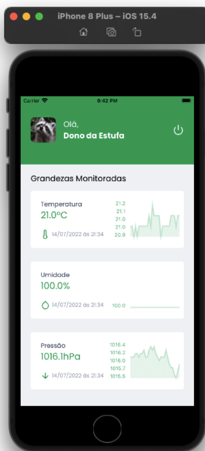
Figura 21 – Dashboard da aplicação no simulador
