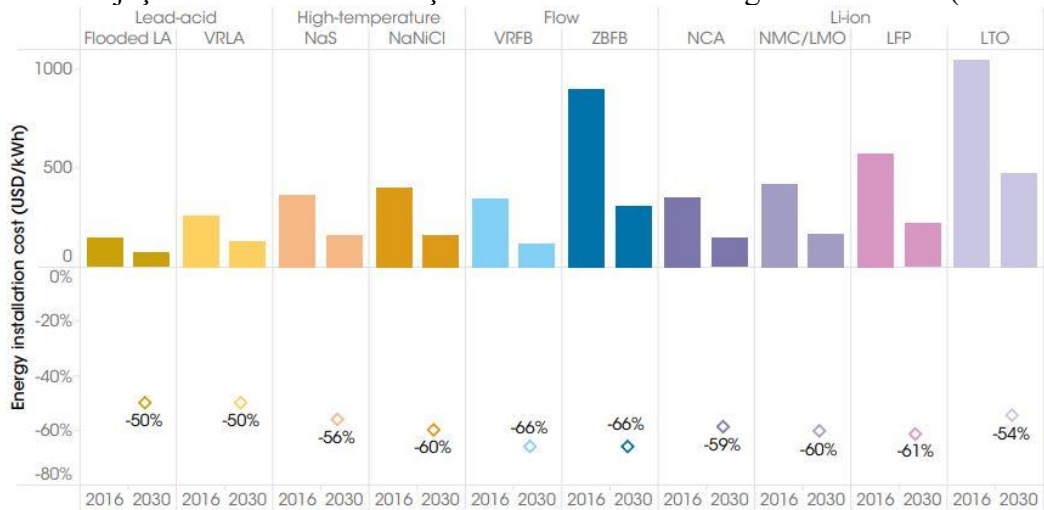
Figura 4 – Projeção de custo de instalação de diferentes tecnologias de baterias (2016-2030).
