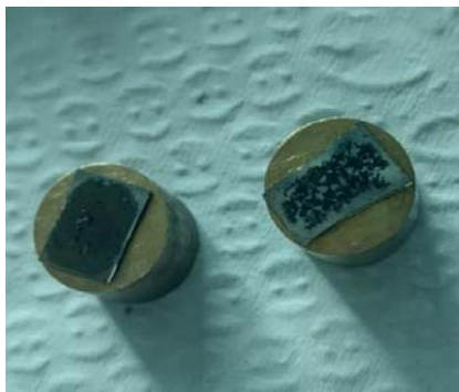
Figura 8. Imagem fotográfica dos stubs preparados para a análise de microscopia eletrônica de varredura. À esquerda, o material Ni/O-CNT, à direita, Ni/N-CNT.
