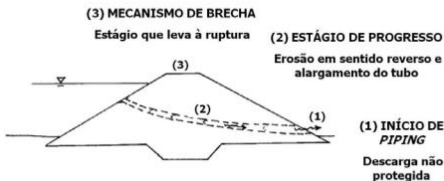
Figura 5. Formação de piping.
