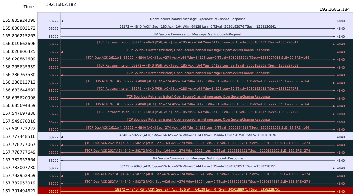
Figura 43 – Retransmissões na abertura de canal de comunicação entre dois dispositivos na rede local
