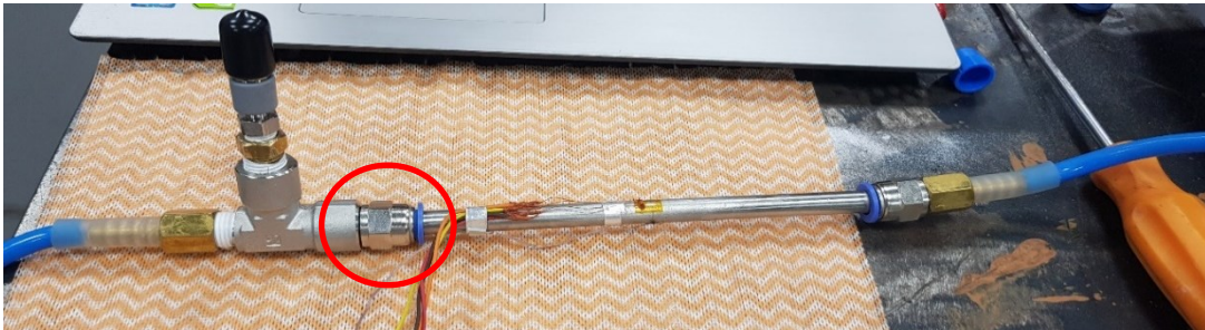
Figura 27 – Fotografia do tubo “A” instrumentado, conectado por engate rápido (ver círculo).
