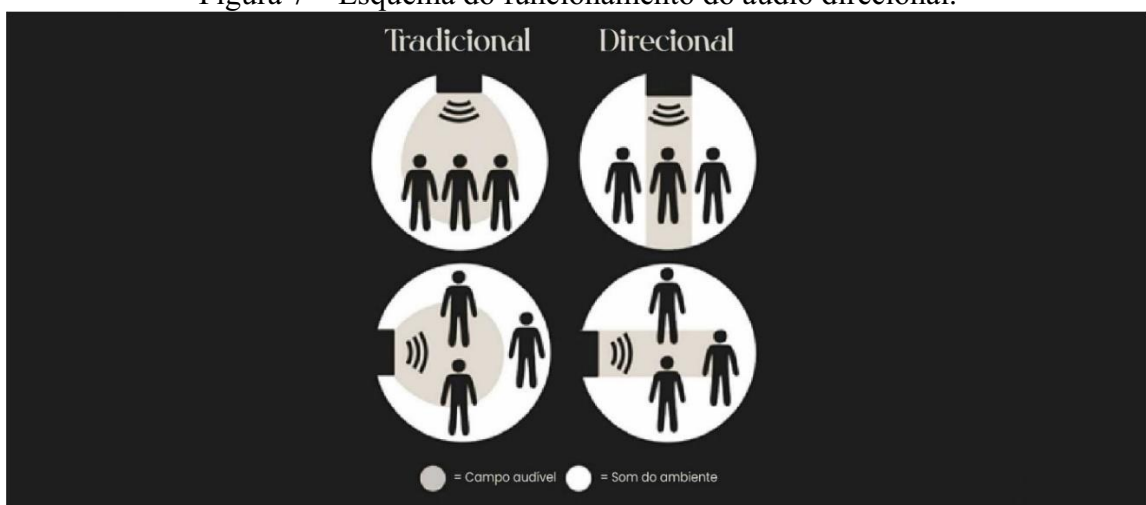
Figura 7 – Esquema do funcionamento do áudio direcional.
