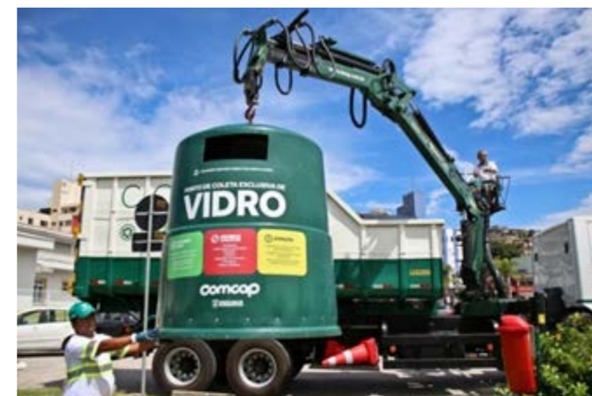
FIGURA 43 - Caminhão com içamento do PEV de vidro utilizado para coleta FONTE: Coordenadoria de Gestão Ambiental CGA - UFSC.
