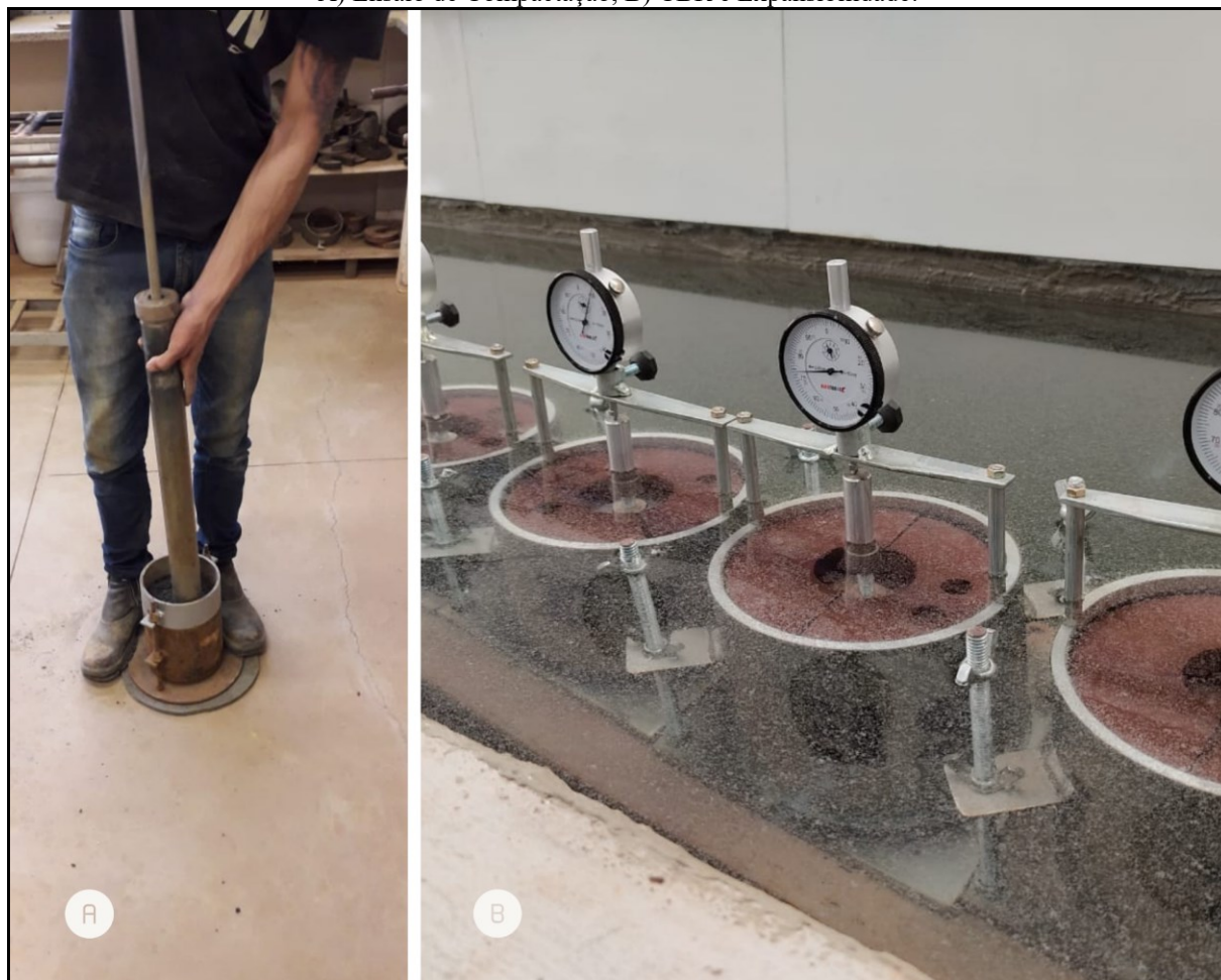
Figura 30 – Caracterização Mecânica das Misturas de Solo (I, II, III, Saibro) + Lodo. A) Ensaio de Compactação, B) CBR e Expansibilidade.
