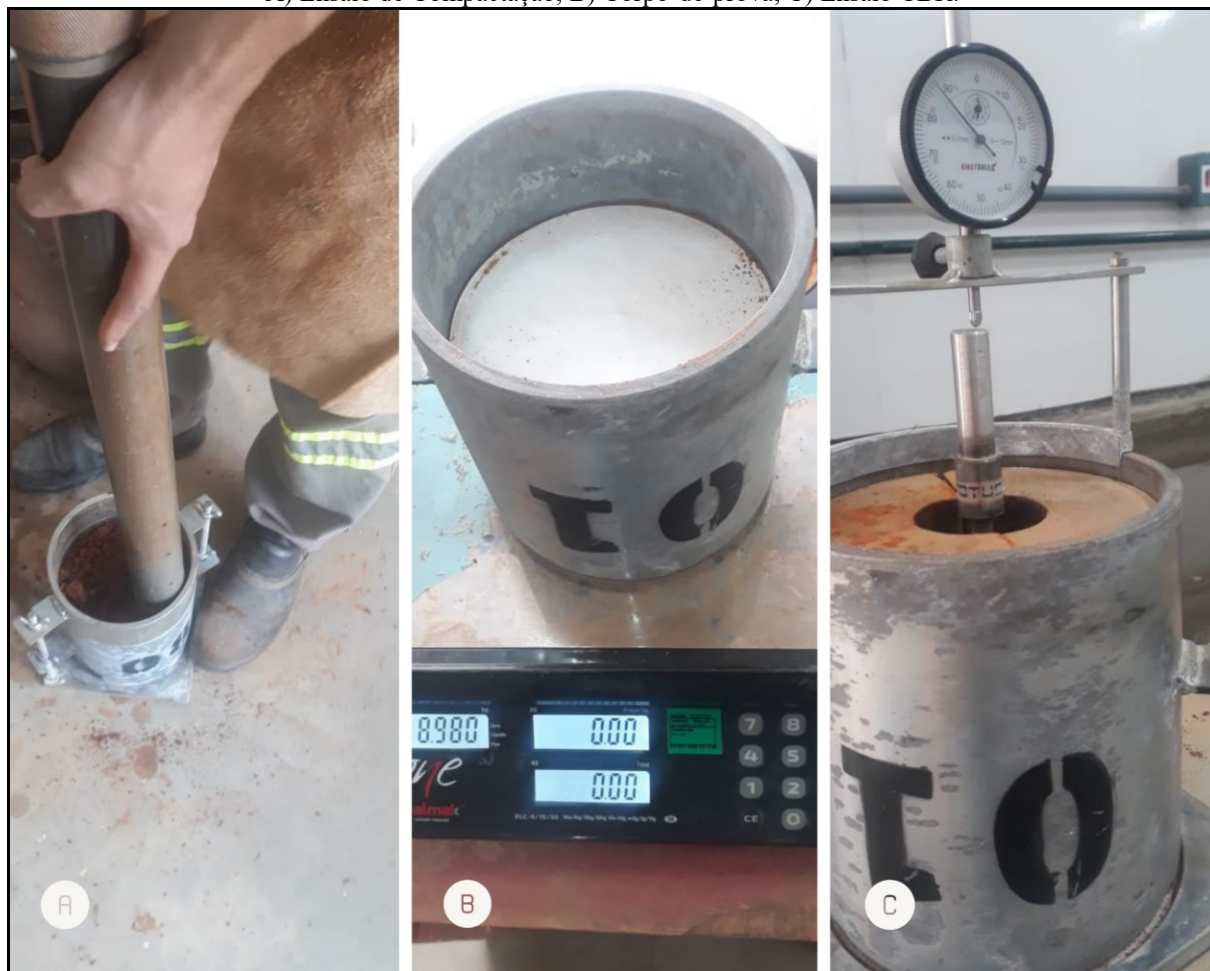
Figura 27 – Ensaio de Compactação dos Solos I, II e III. A) Ensaio de Compactação, B) Corpo-de-prova, C) Ensaio CBR.
