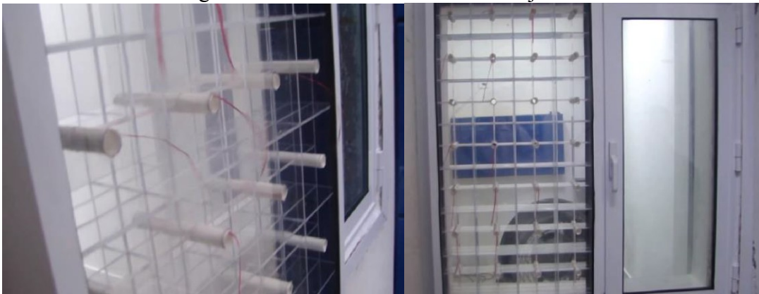
Figura 9 – Ressonadores acústicos em janela
