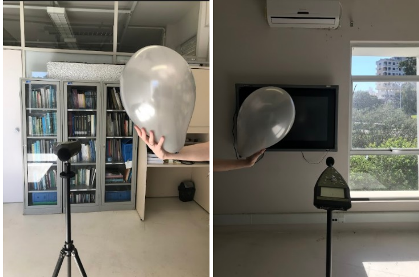
Figura 24 – Recurso utilizado na medição do tempo de reverberação
