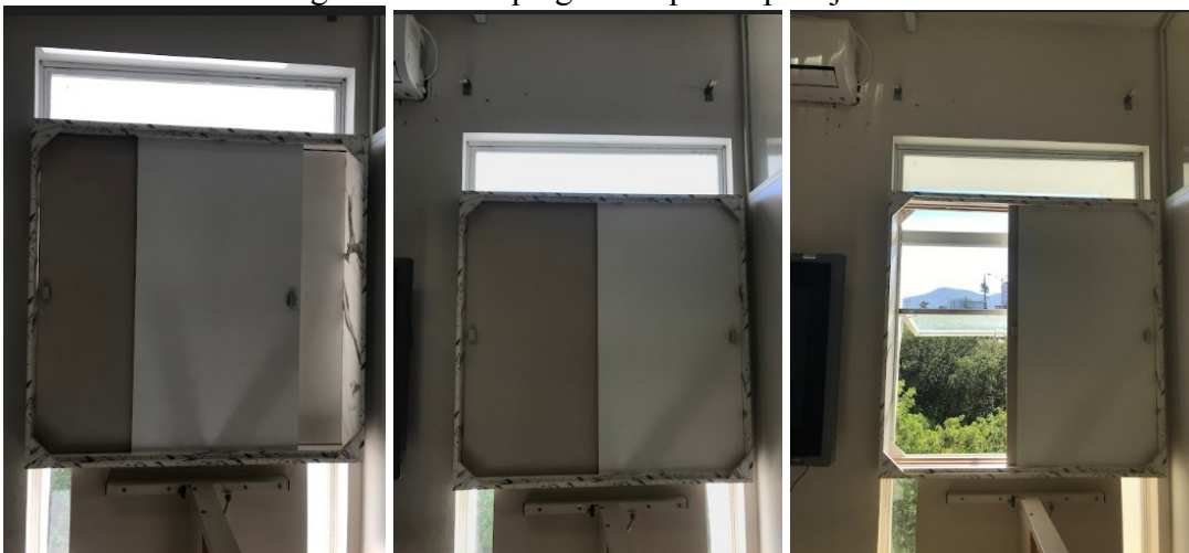
Figura 22 – Acoplagem do protótipo à janela
