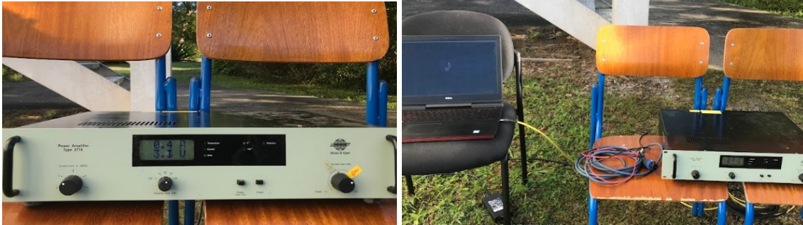
Figura 26 – Materiais utilizados e disposição da instalação para a geração de ruído externo
