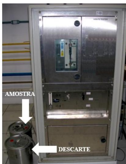
Figura 59 – Recipientes de amostra e descarte de querosene.
