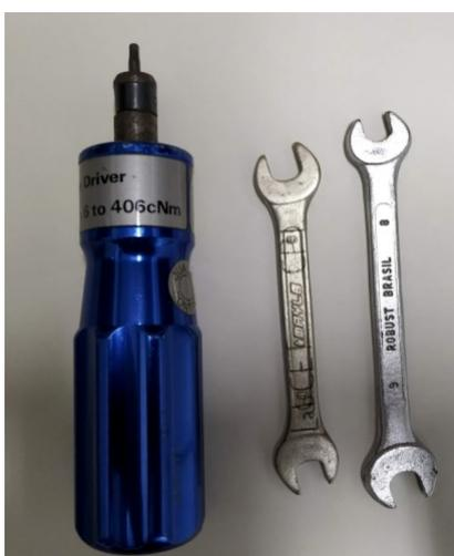
Figura 61 – Chave de torque e duas chaves de boca de 8 mm.
