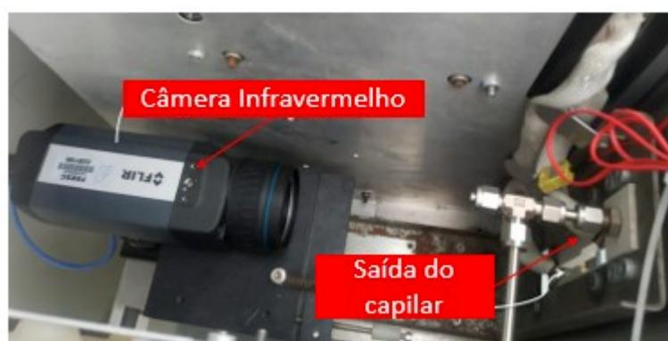
Figura 19 – Câmera de Infravermelho posicionada a 200 mm do capilar.
