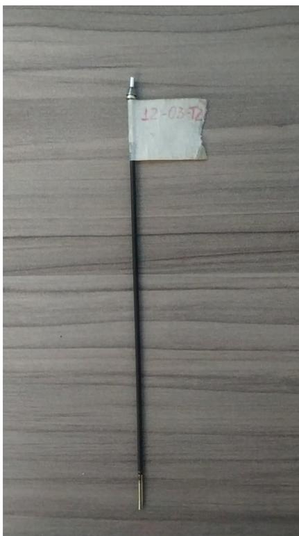
Figura 63 – Tubo capilar testado e identificado.
