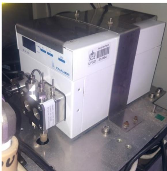
Figura 15 – Bomba HPLC para bombeamento do combustível.
