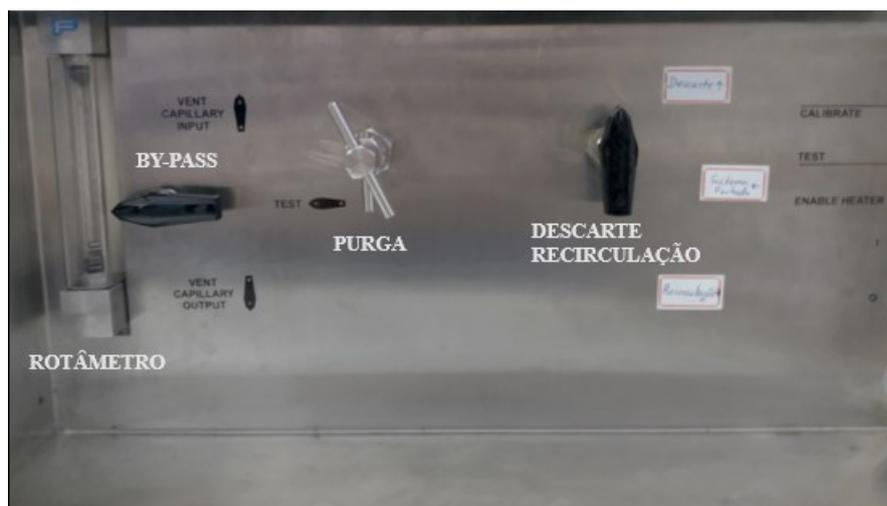
Figura 23 – Painel de válvulas de alívio de pressão (esquerda), purga (centro) e de recirculação/descarte (direita).
