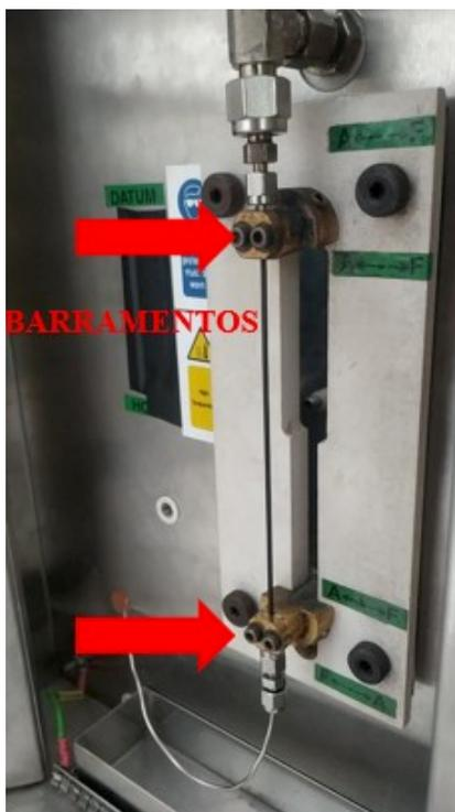
Figura 62 – Tubo capilar conectado ao sistema.
