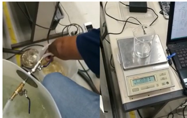
Figura 3.25 – Término do processo de medição de massa de água e tempo de coleta.
