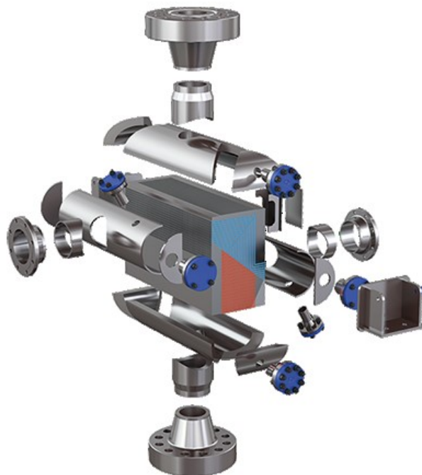
Figura 2.4 – Vista explodida de um trocador de calor com bocal do tipo meia cana.
