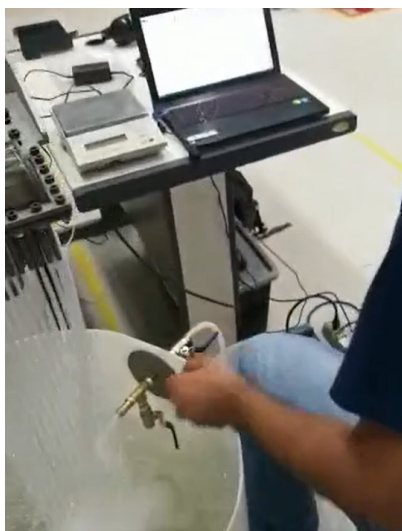
Figura 3.23 – Bancada experimental em funcionamento com coletor encaixado em um dos canais de saída.
