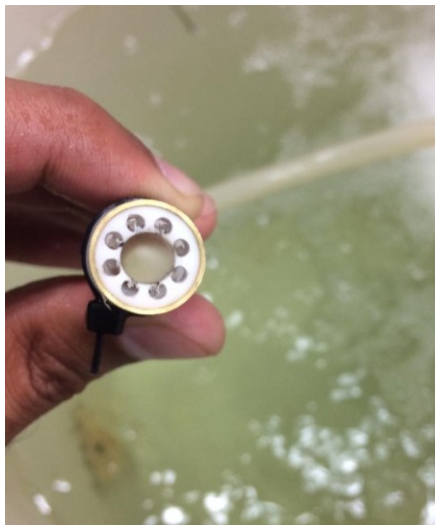
Figura 3.22 – Coletor utilizado na coleta de água ao Becker durante uma medição experimental.
