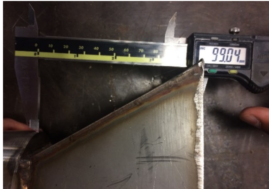
Figura 3.5 – Medição da menor distância entre a saída do duto de entrada e o núcleo do trocador testado por Morteau (2017).
