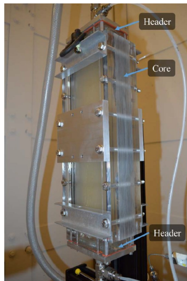
Figura 2.43 – Protótipo de um PCHE construído em acrílico.
