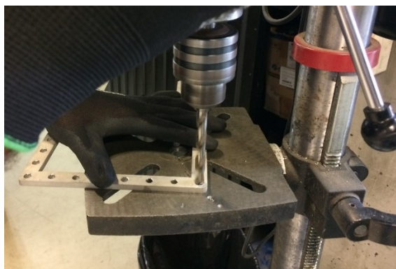
Figura 3.8 – Escareamento dos furos onde passam os parafusos.
