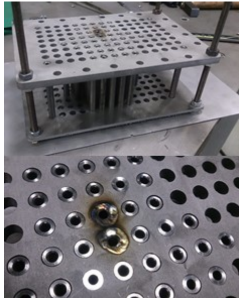
Figura 3.14 – Processo de soldagem dos dutos de saída da seção de testes com a base de solda.
