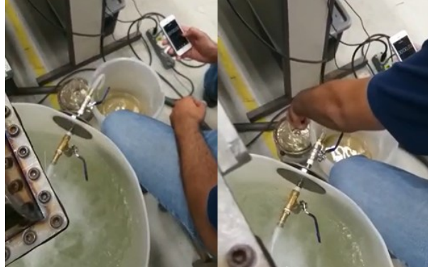
Figura 3.24 – Início do processo de medição de massa de água e tempo de coleta.
