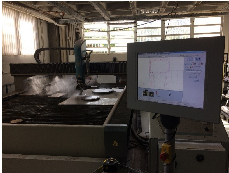
Figura 3.6 – Chapa de inox sendo cortadas pela máquina de corte a jato d'água.
