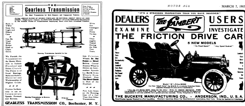
Figura 2-2: (a) Cartaz publicitário de 1906, de uma transmissão de tração por atrito. (b) Anúncio publicitário de 1907, de um automóvel Lambert, com transmissão tipo CVT.
