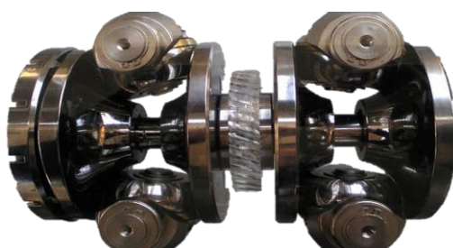
Figura 2-3: Transmissão semi-toroidal de duas cavidades, batizada pela Nissan de Extroid CVT.
