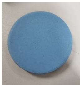
Figura 26: Amostra TC 1185 após ensaio com azul de metileno
