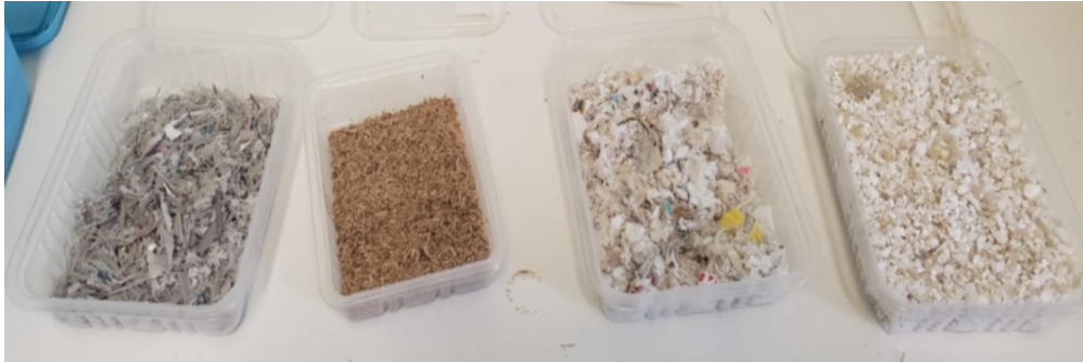
Figura 19: Componentes utilizados na preparação dos compactados (papel/papelão; plástico mole; isopor e biomassa - casca e palha de arroz).
