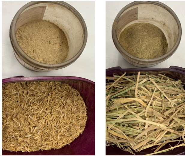
Figura 30: Amostras de biomassa da rizicultura do sul de Santa Catarina – como recebida e moída (60 mesh).
