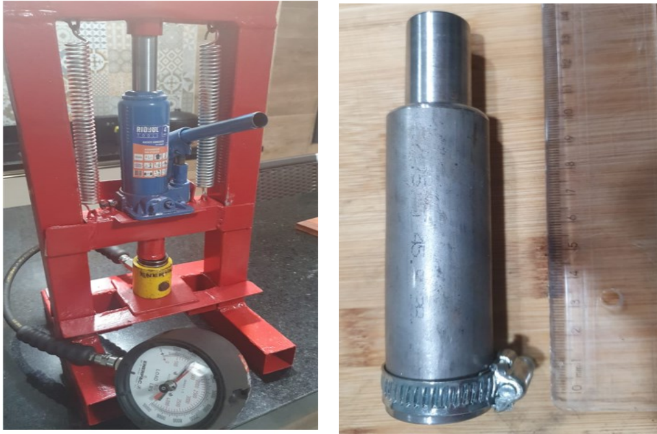
Figura 22: Prensa produzida para o estudo com medição de pressão aplicada (célula de carga) a esquerda. À direita, molde projetado para compactação.
