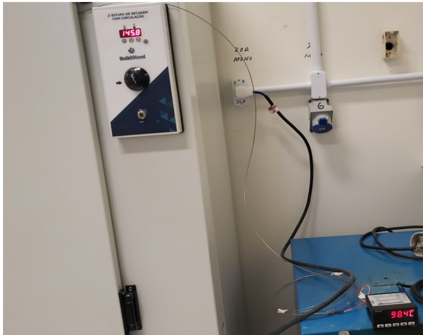
Figura 23: Dispositivo para medição de temperatura da amostra e estufa utilizada.
