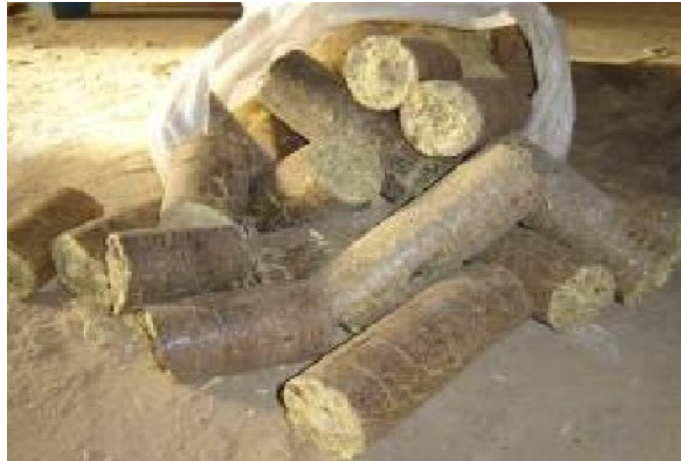
Figura 7: Compactados de biomassa conformados com a utilização de prensa hidráulica.
