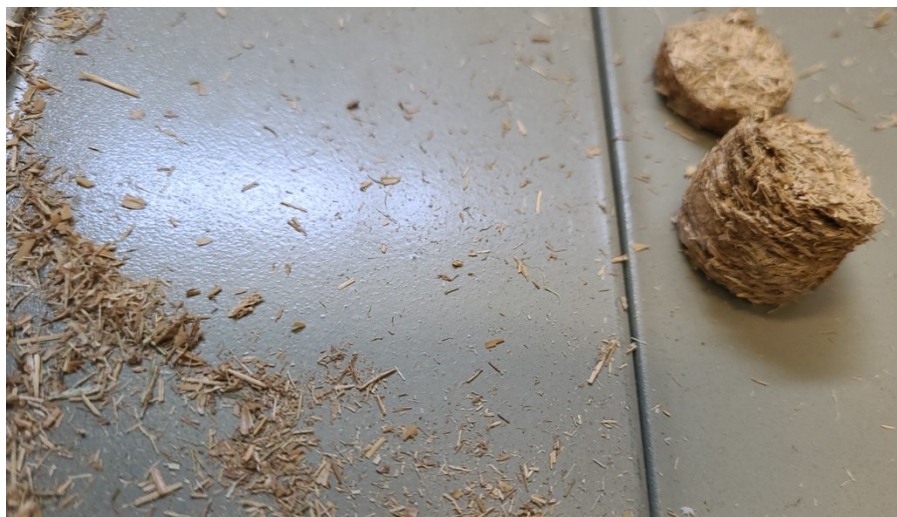
Figura 52: Perda de material nos testes de resistência.
