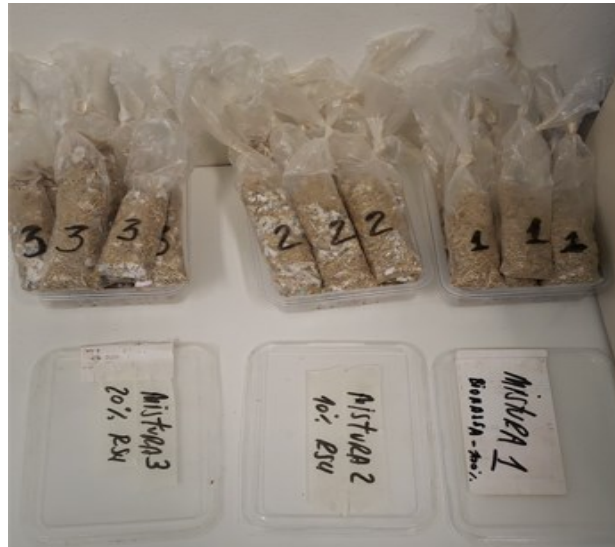
Figura 21: Misturas preparadas para conformação dos compactados (0, 10% e 20% de RSU).
