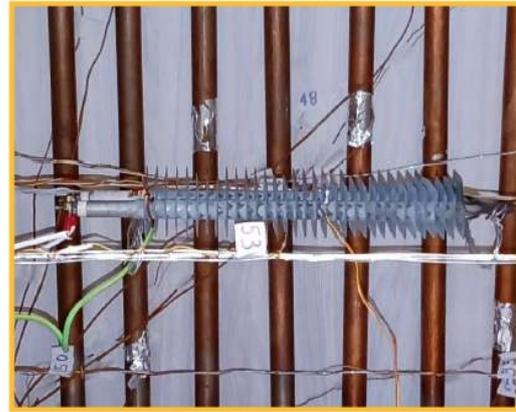
b dissipador de calor aletado de alumínio
