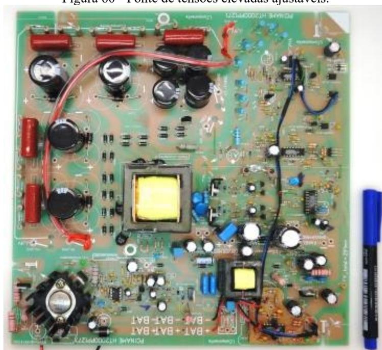
Figura 61 - Placa principal do eletroporador, com fonte auxiliar, microcontrolador e as primeiras versões dos drivers para os IGBTs.
