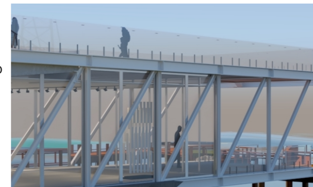
VISTA ESTRUTURA TRELIÇADA METÁLICA E ESQUADRIAS INTERNAS EM ALUMÍNIO E VIDRO Fonte: Acervo do autor (2022)
