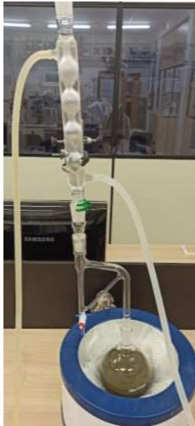
Figura 10 – Fotografia do aparato utilizado para extração por hidrodestilação
