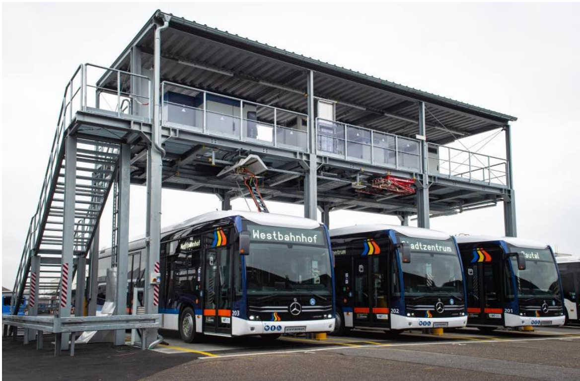
Figura 5 – Sistema utiliza um pantógrafo montado no ônibus elétrico, incluindo gerenciamento remoto que garante alto tempo de atividade durante toda a operação
