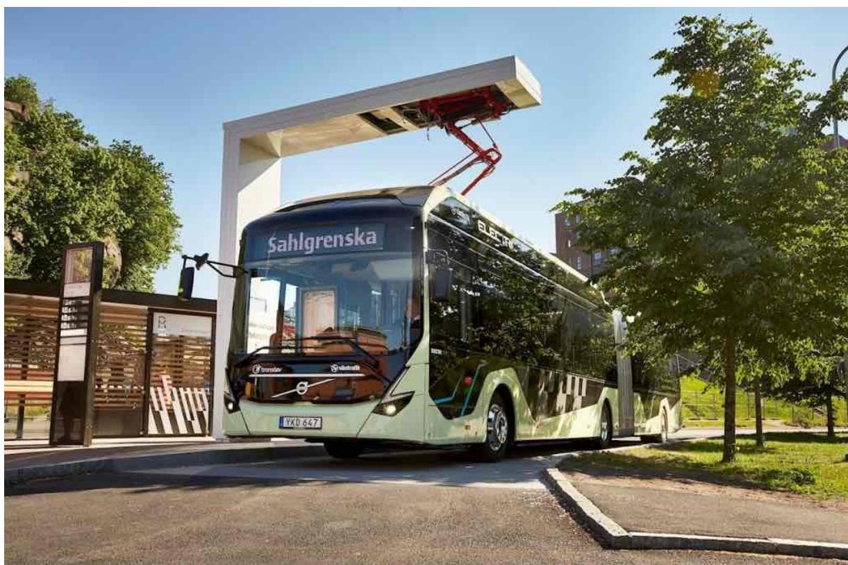
Figura 4 – Sistema utiliza um pantógrafo montado no ônibus elétrico, incluindo gerenciamento remoto que garante alto tempo de atividade durante toda a operação
