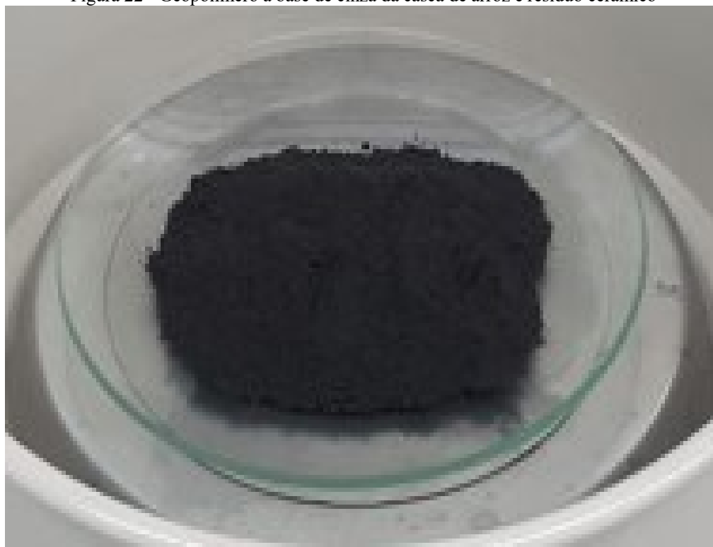
Figura 22 - Geopolímero à base de cinza da casca de arroz e resíduo cerâmico
