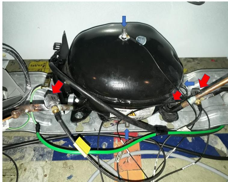
Figura 4.1 – Compressor instrumentado: as setas vermelhas indicam os acelerômetros triaxiais e as setas azuis os uniaxiais.
