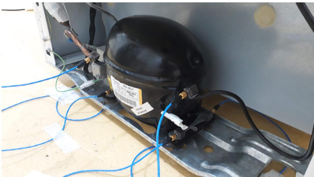
Figura 3.5 – Compressor Embraco instrumentado
