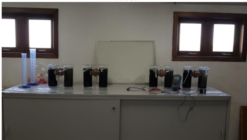
Figura 12 - Setup experimental para a Etapa 2, com quatro CCM operando com DAM no cátodo
