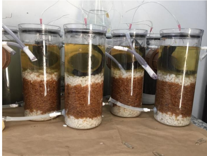
Figura 11 - Estrutura das câmaras catódicas contendo ME
