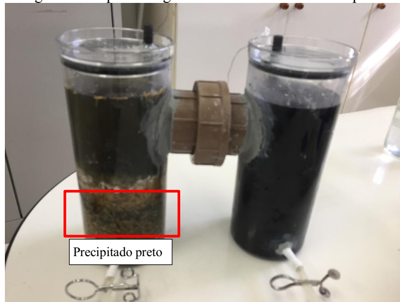
Figura 15 - Aparência geral das CCM ao final da Etapa 1
