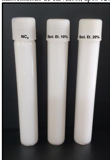
Figura 20 - Detalhes das colorações das soluções etanólicas contendo nanoemulsão de carvacrol, após 120 de estocagem à 25°C.
