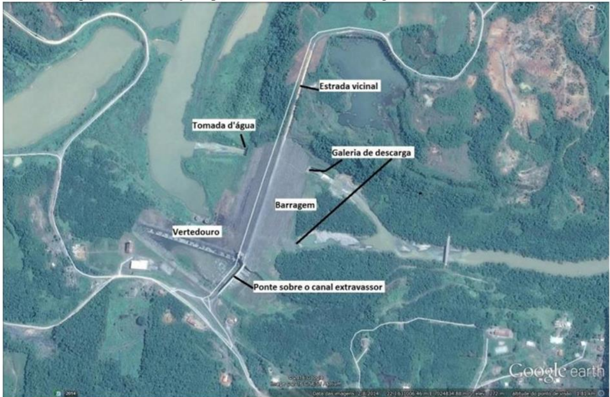
Vista Geral da Barragem Norte com seus respectivos componentes. Fonte: Imagem Google Earth
