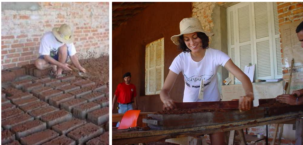
Figuras 7 e 8: Tijolos de Adob curando e sendo produzidos
