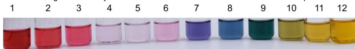
Figura 9 - Variação de cor do extrato de antocianinas de acordo com o pH.
