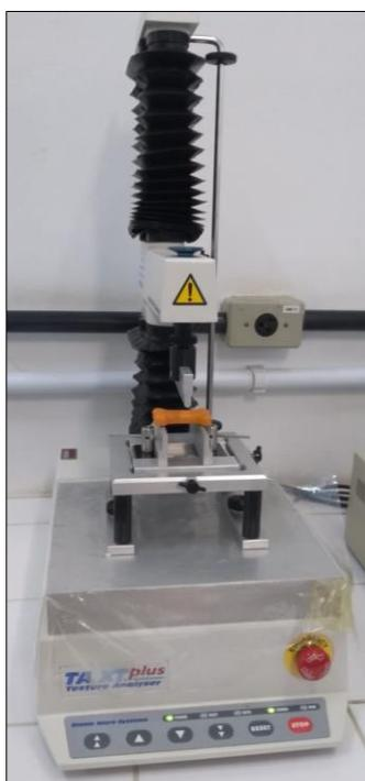
Figura 16: Texturômetro TA.XT plus
