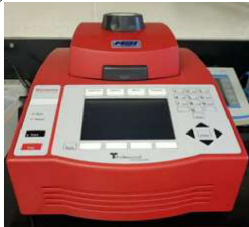
Figura 7. Termociclador convencional de PCR.
