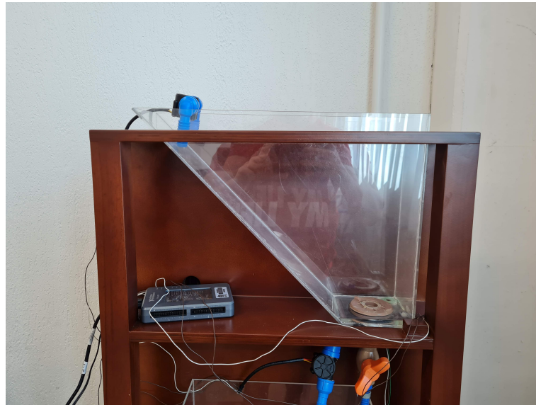
Figura 10 – Tanque trapezoidal montado.
