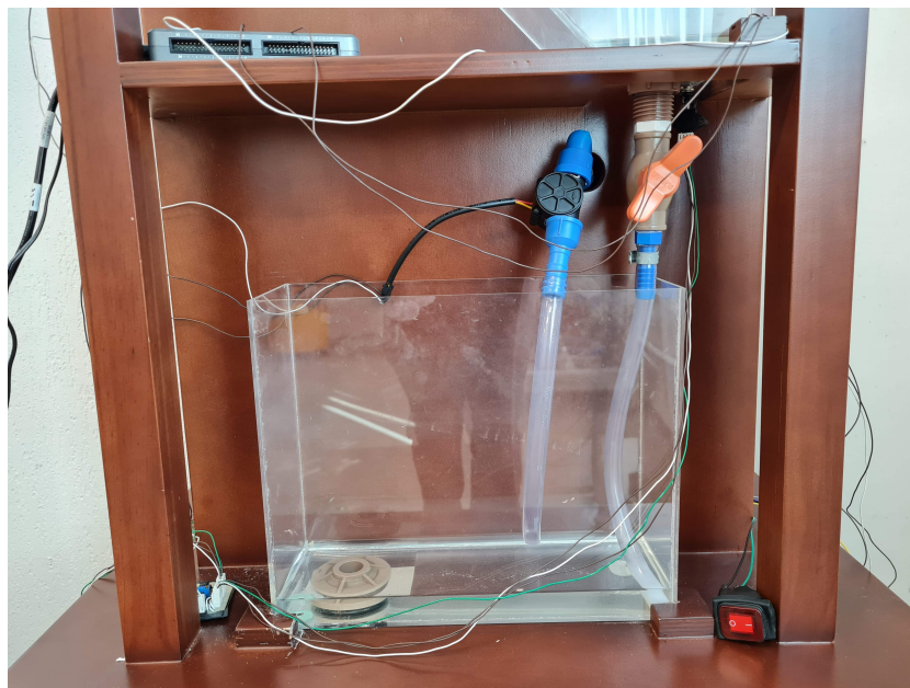
Figura 11 – Tanque retangular montado.
