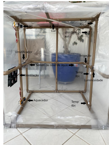
Figura 4 – Casa de vegetação finalizada interior
