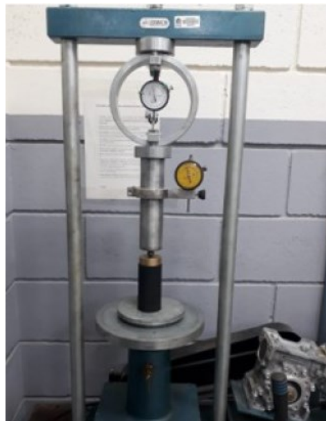
Figura 20 - CP na prensa para ser rompido
