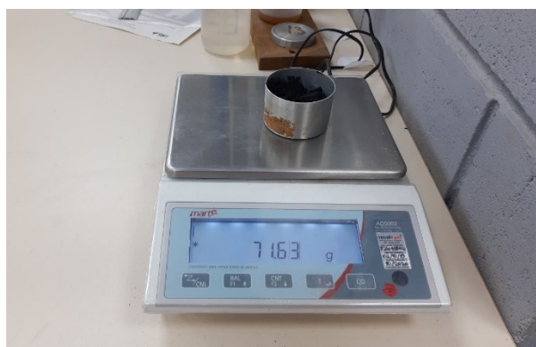
Figura 12- ADF úmida sendo pesada
