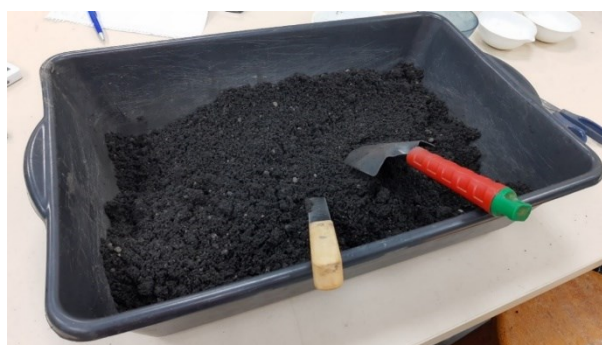
Figura 13 - ADF misturada com cimento
