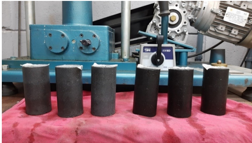
Figura 19 - CPs prontos para serem rompidos após ficarem 24 horas submersos em água
