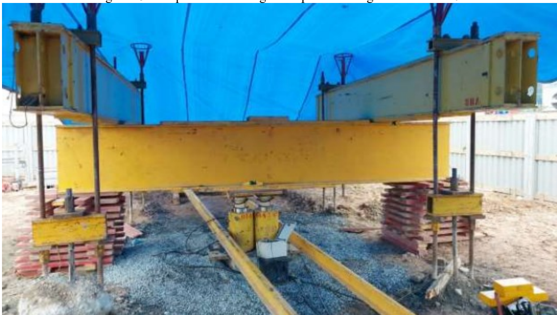
Figura 15 – Esquema de montagem da prova de carga estática PCE.01
