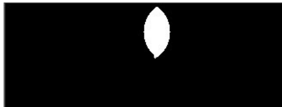
Figura 33 – Região encontrado após processo de erosão.
