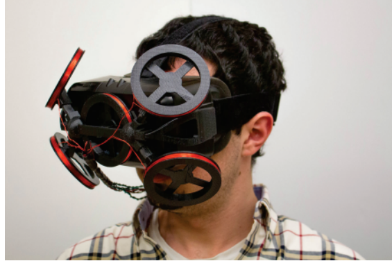
Figura 3 – Dispositivo vestível para eye-tracking aplicado a realidade virtual utilizando SSC.
