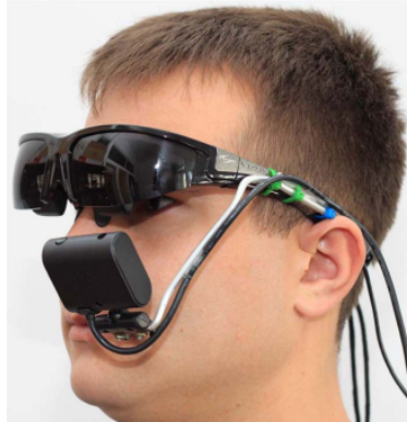
Figura 1 – Sistema de eye-tracking por VOG vestível montado na cabeça.
