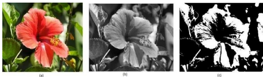
Figura 7 – (a) Imagem em RGB; (b) Imagem em escala de cinza; (c) Imagem binária, retirado de (PATEL; PATEL; PATEL, 2018).
