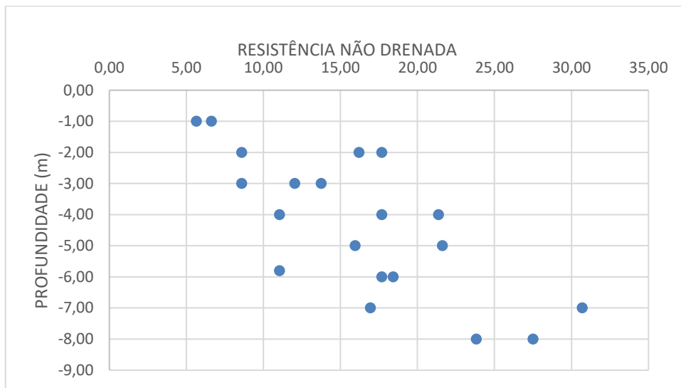
Figura 30 – Compilado dos ensaios de palheta efetuados na obra 2.
