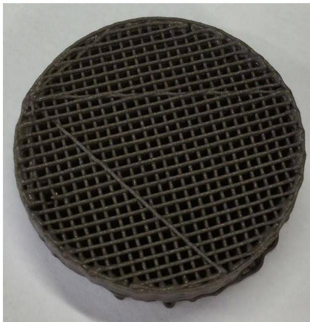
*Figura 7 Suporte geopolimérico impresso por manufatura 3D.*
