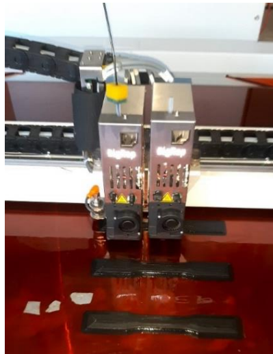
Figura 38 – Cabeçote da impressora 3D utilizada, modelo BigRepOne.
