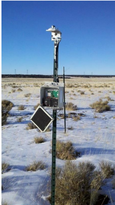
Figura 4 – Sensor de irradiância e sistema embarcado.
