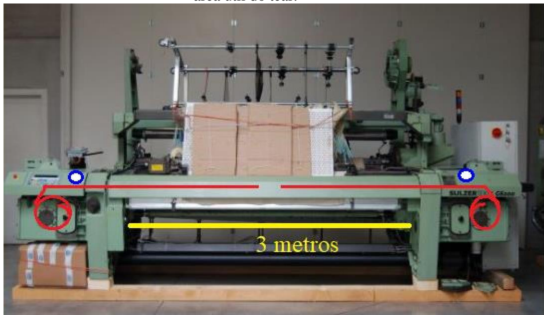
Figura 12 - Localização da fita de carbono dentro do Tear G6200 da marca Sulzer. Em vermelho o componente, em azul as roldanas que o tracionam e em amarelo a dimensão da área útil do tear.
