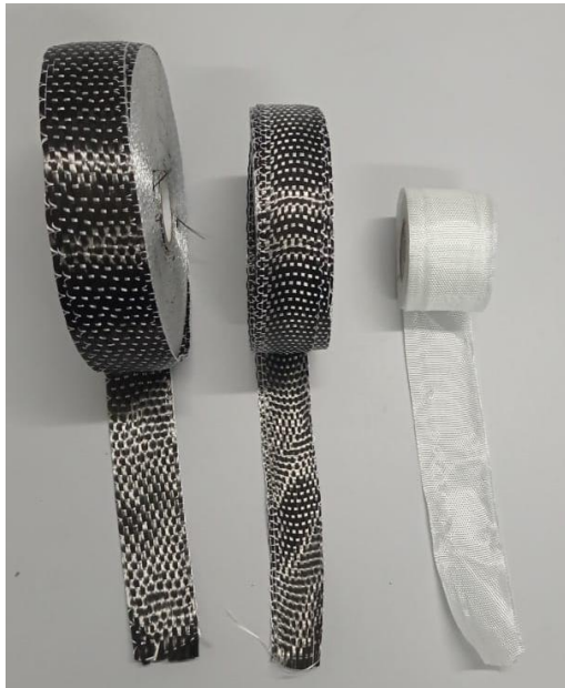
Figura 16- Fibra de carbono unidirecional de alta gramatura, menor gramatura e de vidro respectivamente.
