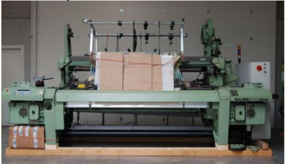
Figura 11 – Tear G6200 da marca Sulzer.
