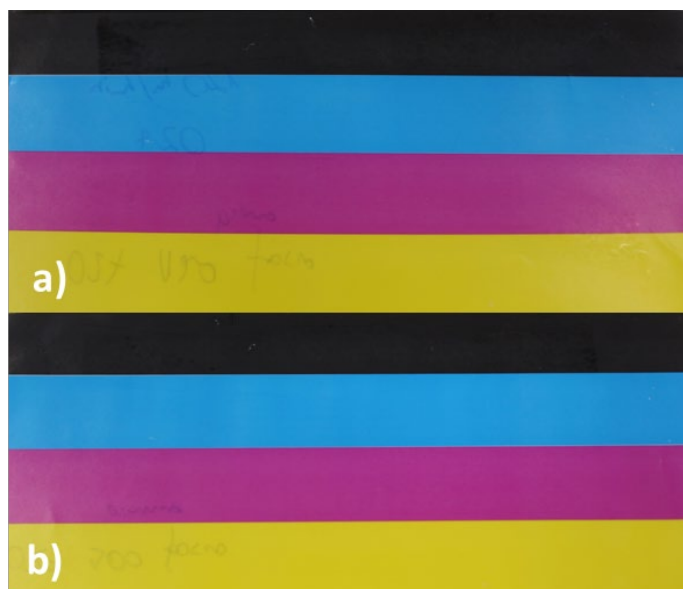
Figura 16 - Resultado do teste de abrasão ( rub test ) na amostra 4 (a) e amostra 7 (b)
