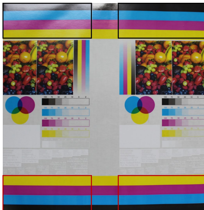
Figura 13 - Destaque das regiões da amostra ensaiadas no rub test : em preto (sem calço) e em vermelho (com calço de branco)
