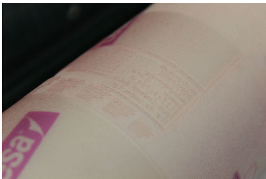
Figura 7 - Clichê flexográfico de fotopolímero
