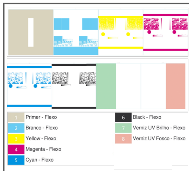
Figura 10 - Projeto esquemático apresentando a sequência de impressão dos componentes
