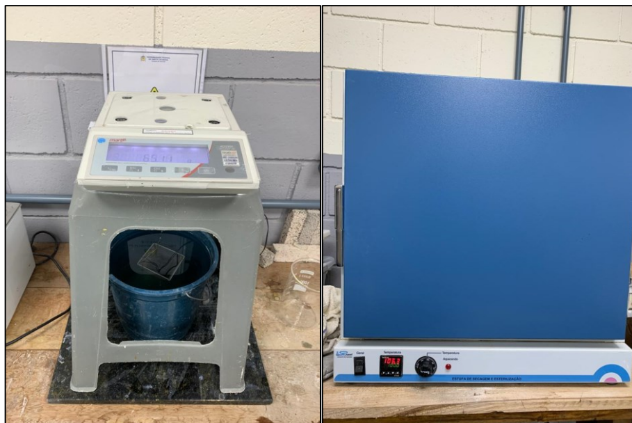
Figura 16 – Equipamentos para as propriedades físicas no estado endurecido: a) Ensaio de Arquimedes; b) Estufa.
