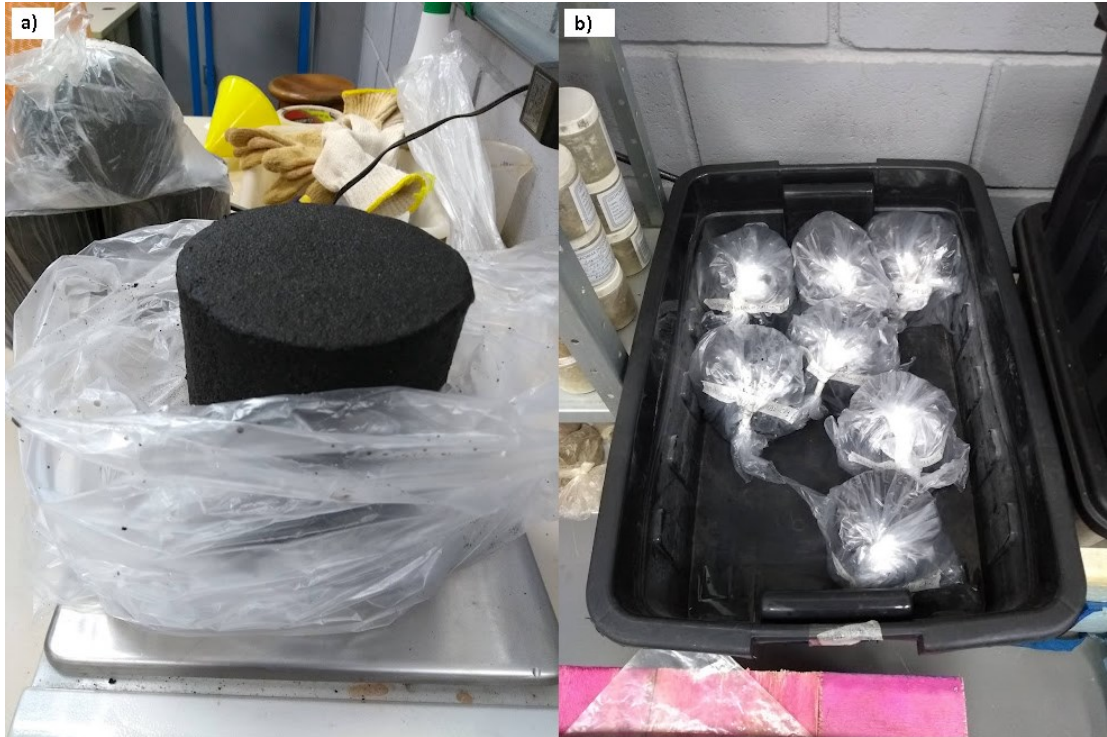
Figura 24 - (a) corpo de prova embrulhado e (b) corpos de prova dispostos na caixa de PVC.
